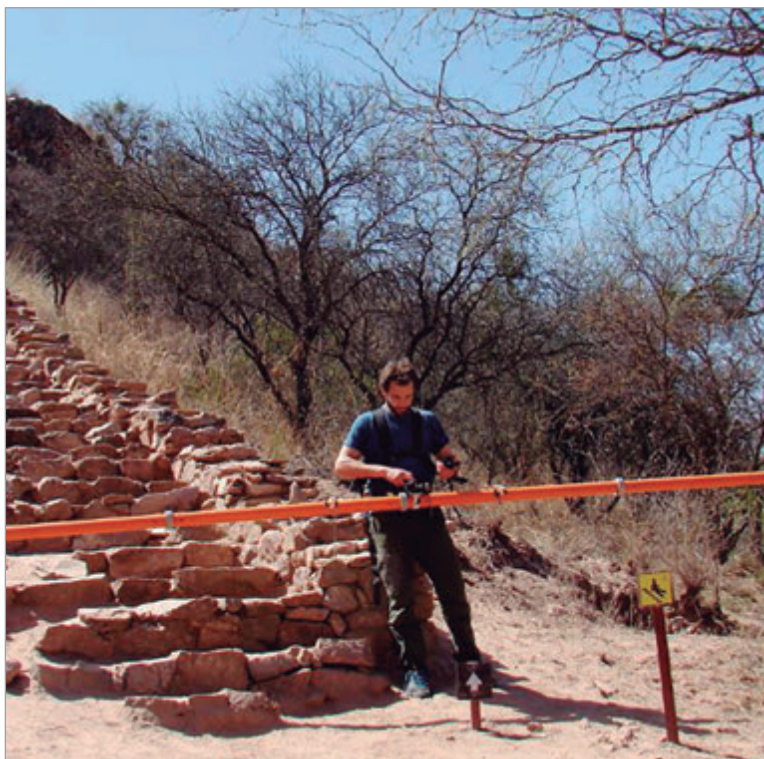
El método consiste en detectar la conductividad eléctrica del suelo
