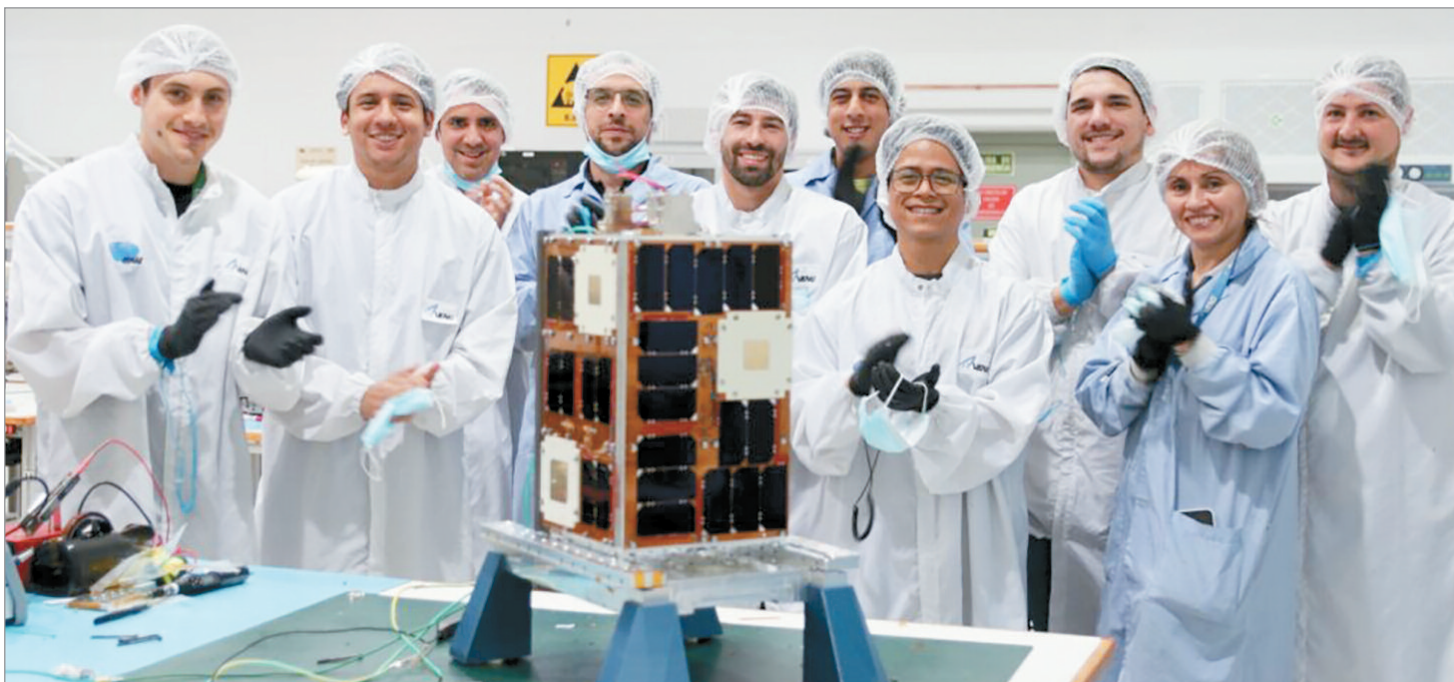
ATENEA es un microsatélite de tipo CubeSat 12U
