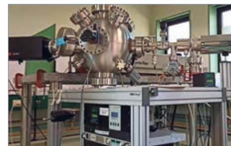
Sistema de deposición por láser pulsado del Laboratorio de Ablación Láser
